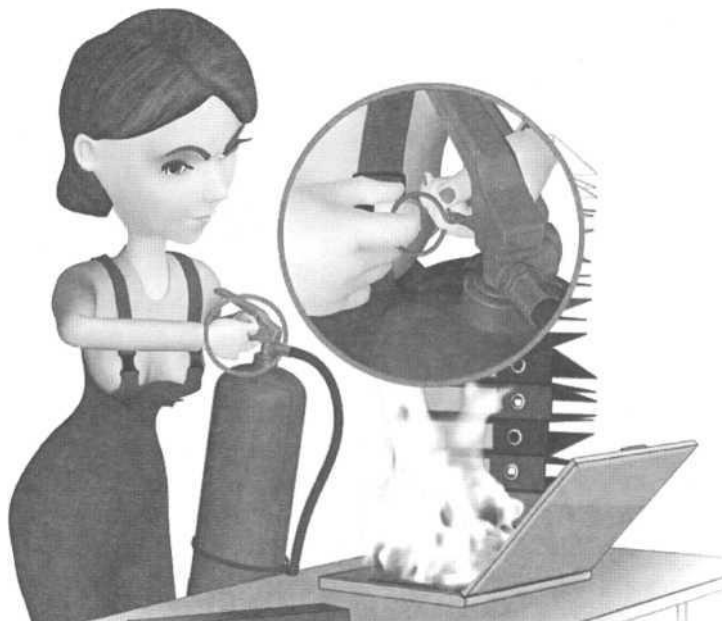
Рис. 49 — Приведение в действие огнетушителя
